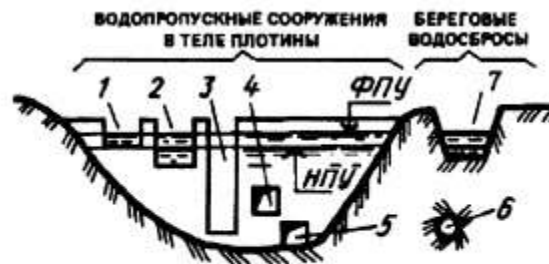
Рис. 4.1. Водопропускні споруди гідроузла:
