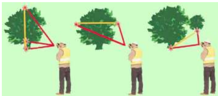
• Мал.6. Порядок проведення робіт далекоміром
